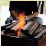
約900度の火気であぶる。表面に浮き出た油分を拭き取り、磨きをかけて艶を出す。太いものは、すべて手作業。
