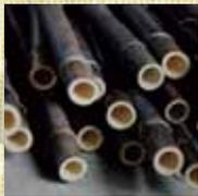
出荷する長さにカットする。太いものは基本的に2m規格。関東規格では一間（いっけん）（約1.82m）だが、関西規格の2mにしておけば全国的に対応が可能。
