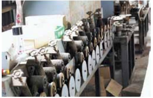
奥の電気炉で熱せられローラーで伸される
