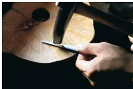
ハンマーでわずかな刃の反りを調整して仕上げる
